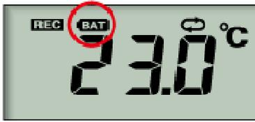
L'indicatore di sostituzione della batteria viene visualizzato in base al calcolo dell'uso che viene fatto della batteria stessa. È possibile che compaia prima di quando indicato sopra. La durata della batteria dipende dall'ambiente di misurazione, dall'intervallo di registrazione, dalla qualità della batteria in uso e dalle
